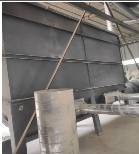
破碎脉冲布袋除尘器
